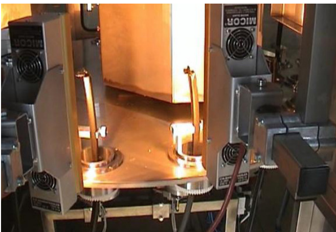
Rundautomat mit Umluft- oder Infrarot-Trockner
