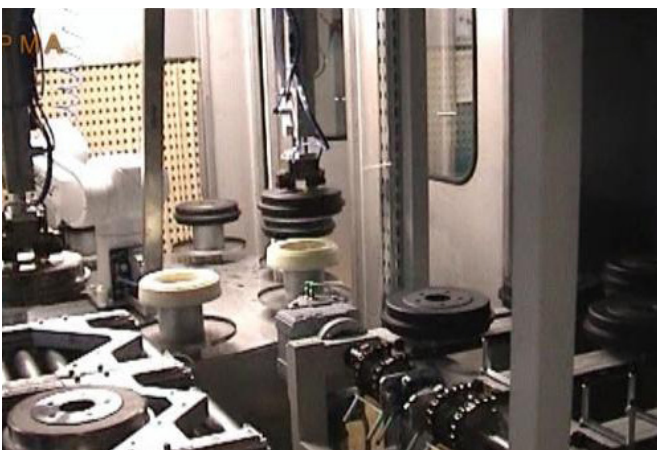
Rundautomat vollautomatisch integriert in Fertigungslinie
