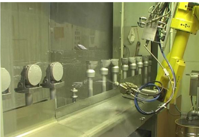
Roboter zur Verkürzung der Rüstzeiten bei häufigem Teilewechsel
