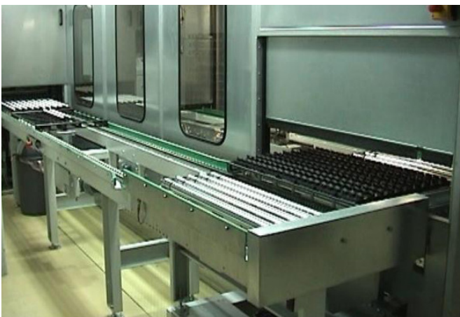
Flächenspritzer mit Palettentransport und Tragfachtrockner
