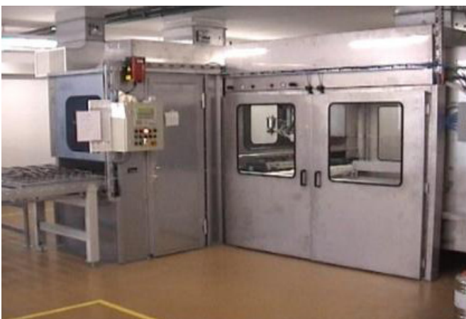
Flächenspritzer mit 3-Achsen-Lackierung und Durchlauf-trockner
